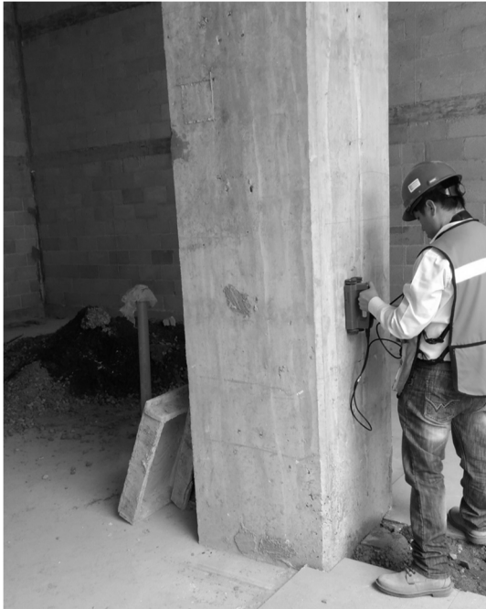
Fig. 2 Imagen en la que se busca determinar el diámetro del acero longitudinal en columna
