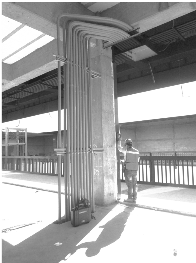
Fig. 1 Imagen en la que se busca determinar el diámetro del acero longitudinal en columna
