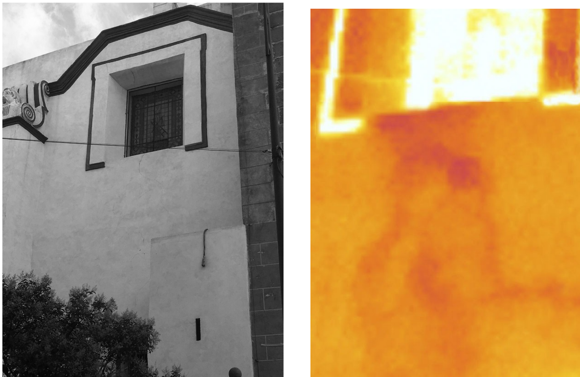
Fig. 1 Imagen termo-gráfica para determinar la trayectoria de agrietamientos previos, con resane superficial (puesto que no se aprecian desde el exterior), pero sin inyección de
